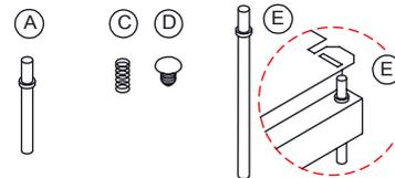
(E) SE EMPLEA PARA MODELOS DE VARIAS PUERTAS POR TAQUILLA PARA LOS TAPES INTERMEDIOS; SIRVIENDO ASI DE PIVOTE SUPERIOR PARA LA PUERTA DE ABAJO Y DE PIVOTE INFERIOR PARA LA DE ARRIBA
